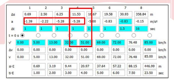
Si nota che, nel momento in cui il conducente dell'autocarro intuisce la turbativa viaggiava ad una velocità di circa 76 km/h e si trova a circa 88 metri (somma dei delta s) dal punto in cui si arresta.
